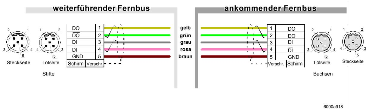
Der Schirm muss konzentrisch und großflächig auf die Verschraubung (Gewinde) geführt sein.
